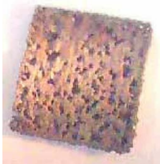
Рис. 23 Внешний вид спеченного монослоя (смесь № 3). Режим ЛВ – P = 14.3 Вт, v = 21 мм/с.
