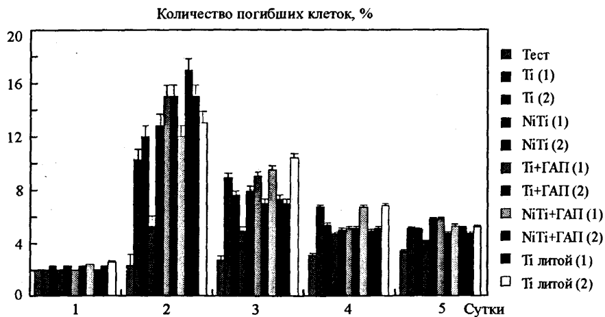
Рис. 5. Количество поврежденных клеток по дням эксперимента для исследованных материалов и вариантов эксперимента
