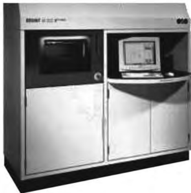
Рис. 1.34. DSLS(M)-процесс — установка EOS M250Xtended (спекаемый объем 250 \times 250 \times 180 мм, \text{CO}_2 -лазер мощностью 240–180 Вт, толщина слоя 0,02 мм, точность \pm 0,05 мм)
