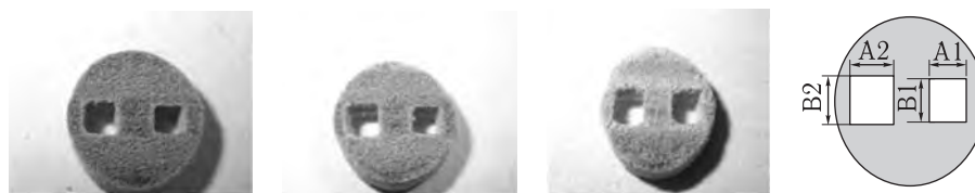
Рис. 4.52. Послойный лазерный синтез фильтра с заданным направлением протока. Скорость сканирования V = 400/1 = 8,5/3400 см/с, диаметр лазерного пятна d_n = 300 мкм
