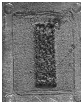
Рис. 3.41. Внешний вид спеченного монослоя порошковой композиции Ni-Ti = 1 : 1. Условия обработки соответствуют рис. 3.35
