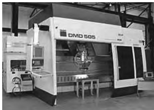
Рис. 1.43. Установка фирмы Trumpf для послойной 3D-лазерной наплавки
