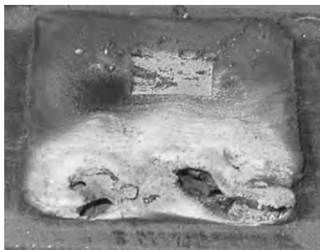
Рис. 3.42. Внешний вид СЛС при отсутствии контроля. В центре отчетливо виден квадрат, который предназначался к обработке. Условия ЛО см. рис. 3.38
