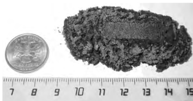
Рис. 5.4. Внешний вид спека при не контролируемом лазером СВС в системе Ni–Ti [407]
