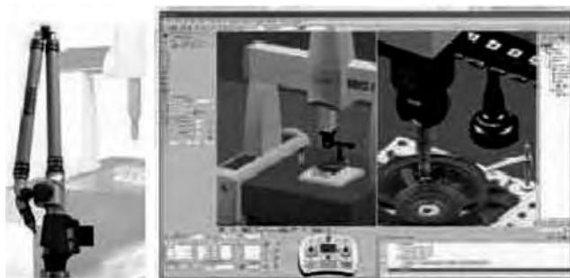
Рис. 1.23. Ручной 3-мерный сканер Metrological XG с программным пакетом Silma XG
