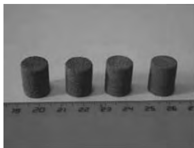
Рис. 6.9. Общий вид однородных по высоте фильтрующих элементов. Слева на право: 1 – размер фракции 63–100 мкм, высота приращения по слоям h = 200 мкм; 2 – 100–160, h = 200 мкм; 3 – 63–100 мкм, h = 100 мкм; 4 – < 50 мкм, h = 200 мкм
