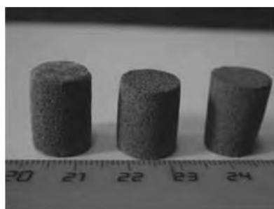
Рис. 6.10. Общий вид неоднородных по высоте фильтрующих элементов. Слева на право: 1 – 63–100 мкм, h = 200 мкм (9 вертикальных цилиндров-каналов видны как «белесые» пятна на поверхности); 2 – 63–100 мкм (const), h = 100, 150, 200, 250, 300 мкм по 3 мм; 3 – изменялся размер: < 50, 50-63, 63-100, 100-160 мкм по 4 мм, h = 200 мкм
